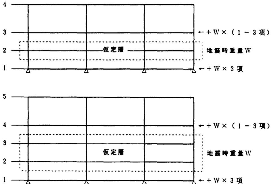
図 2.14 地震時重量の振り分け方法
