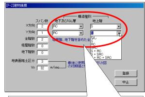
構造種別の入力方法は、X, Y方向毎に、地下階の構造種別、地上階の構造種別を別々に、コンボボックスでの選択入力となりました。
